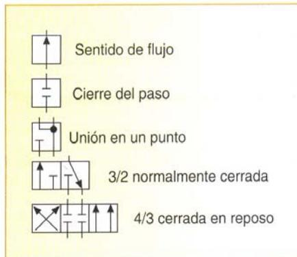
Formas de conexiones internas de las vías de una válvula.
